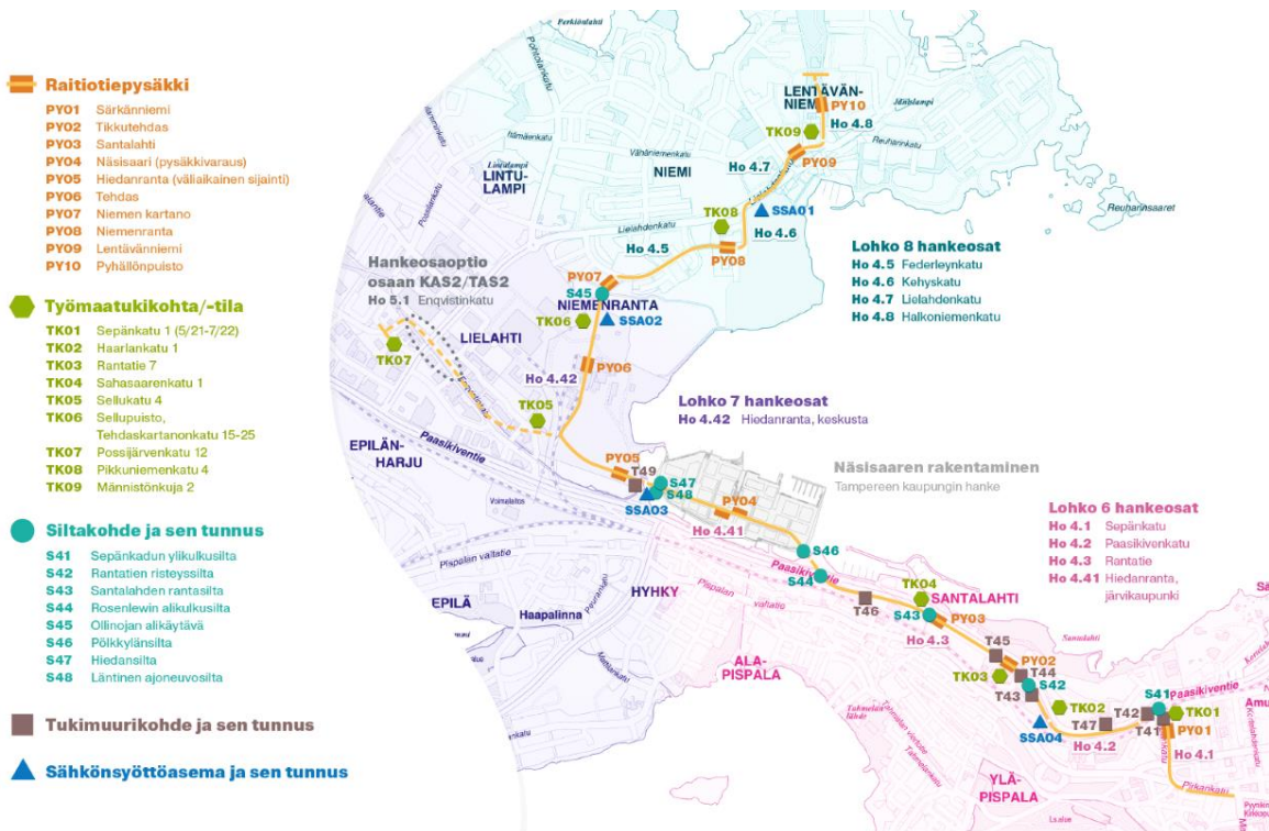
Kuva 8. Osan 2 syöttöasemat (SSA01-SSA04) ja muita rakenteita kartalla.
