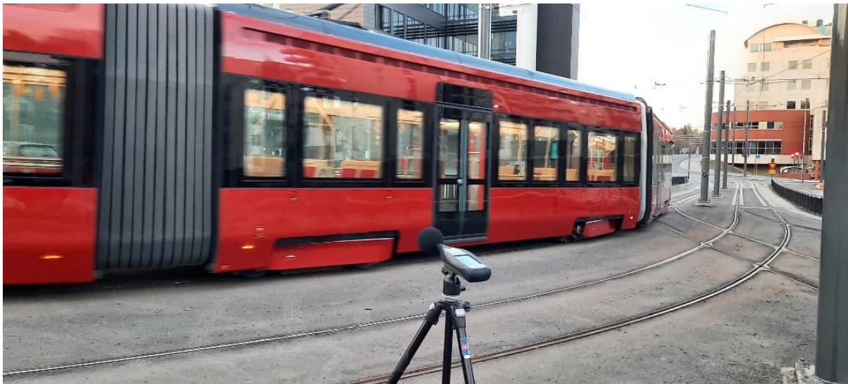
Kuva 3. Raitiotien koeliikenteen melumittausta vuonna 2021.
